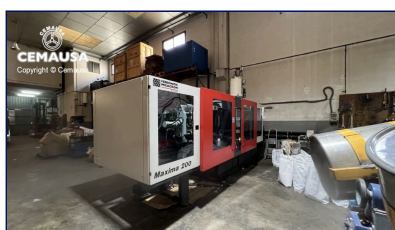
Inyectora termoplástico 200 ton.
