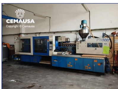
Inyectora termoplástico 300 ton.
